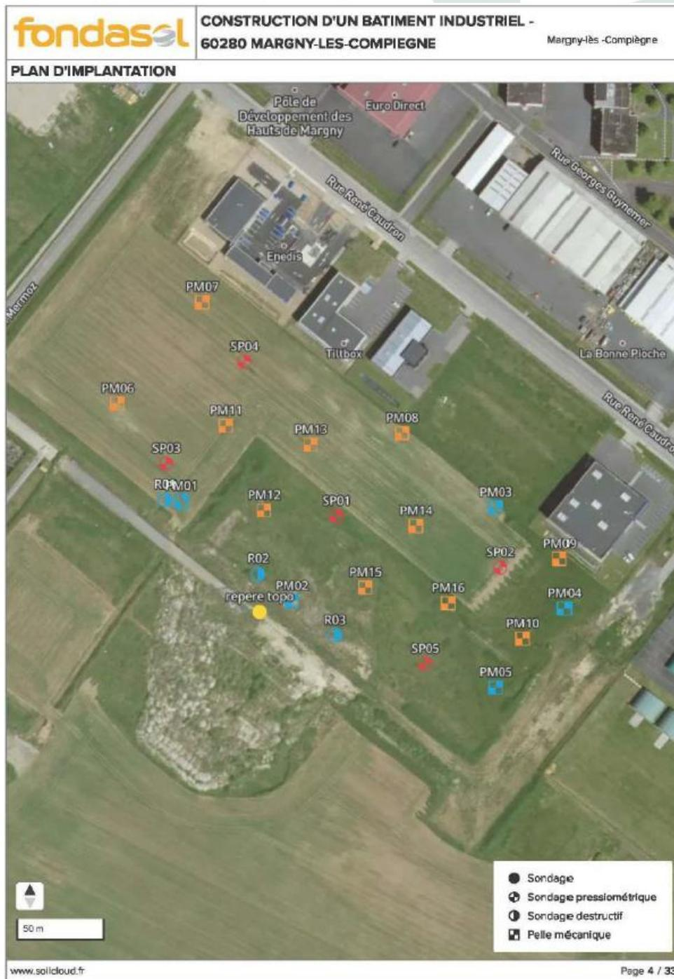
Localisation des essais de perméabilité – Source : Fondasol
